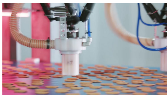
健松智能机器人通过视觉识别及检测拾取薯片应用场景
